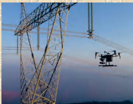
проводов ЛЭП в качестве катушки-передатчика будет создана достаточно значительная область, находясь в которой дроны, оснащенные принимающей катушкой, способны подзаряжать свои аккумуляторы без необходимости прямого подключения к электросети.
